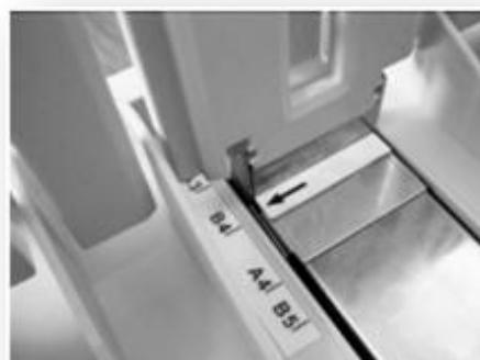
根据接纸台上的刻度调整出纸导向板的位置。
