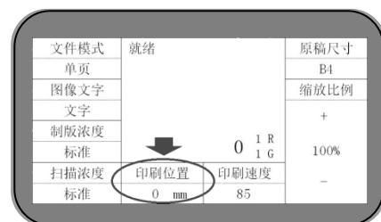
通过操作部的 [ 印刷位置 ] 按钮进行调整。无论机器是在停止状态还是动作状态，进行调整时以中心为基准，移动刻度显示在显示器左下侧。
