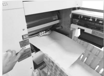
iii ) 一直按住 [ 滚筒旋转按钮 ] 直至发出轻微的 [ 碰 !! ] 的响声。滚筒至所在位置时会自动停止。
